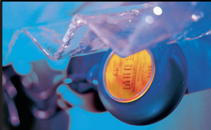
I GALLEGGIANTI ELETTROMECCANICI. Si tratta di regolatori che si basano sulla spinta di galleggiamento muniti di micro interruttore interno che commuta attivando o disattivando la pompa.
